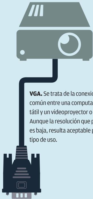
**VGA.** Se trata de la conexión más común entre una computadora portátil y un videoprojector o cañón. Aunque la resolución que permite es baja, resulta aceptable para este tipo de uso.
