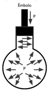
Un ejemplo del principio de Pascal es la jeringa de Pascal: un recipiente lleno con un líquido y sellado con un émbolo, si al émbolo se le aplica una fuerza, ésta se transmitirá íntegra al líquido, que a su vez ejercerá una presión de la misma intensidad en todas direcciones. Si el recipiente tuviera orificios, el líquido saldría con la misma presión producida por la fuerza aplicada al émbolo.
